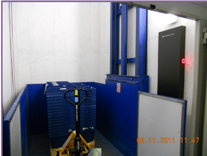
Leitura nos Pórticos RFID
